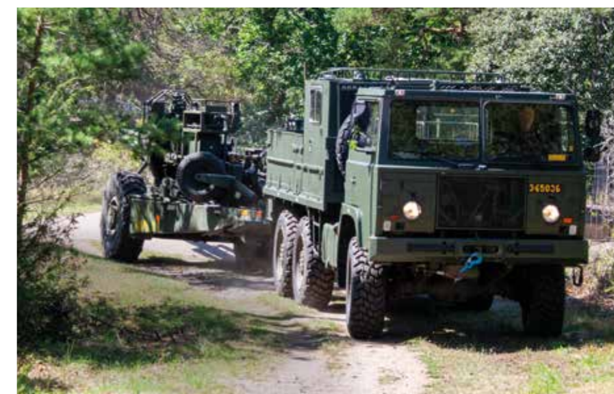
En rörlig kustartilleripjäsa m/80, allmänt kallad 12/80, grupperas för förevisning, dragen av en terrängbil 40 och bakom ratten Benny Larsson. Foto: Ingmar Elofsson.
