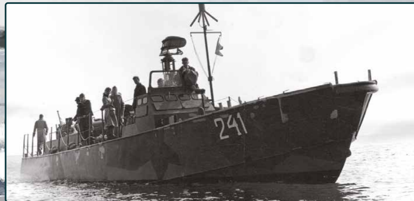
200-båt av äldre snitt, här TpbS 247, bredd över allt 4,0 meter, längd över allt 21,0 meter. Ur Lilian Varenius samling, Sjöhistoriska museet.
